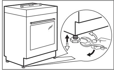
Utilisez les petits pieds situés sous l'appareil pour mettre la surface supérieure de l'appareil de niveau avec les autres surfaces environnantes.
