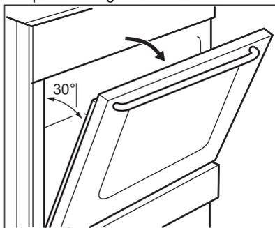
2. Saisissez les deux côtés du cache (B) situé sur l'arête supérieure de la porte et poussez-le vers l'intérieur pour permettre le déverrouillage du système de fermeture.
