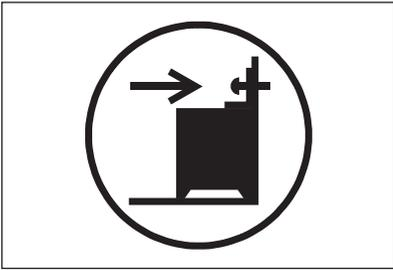
1. Installez la protection anti-bascule 331 - 336 mm en dessous de la surface supérieure de l'appareil et de 80 à 85 mm du côté de l'appareil, dans l'orifice circulaire situé sur un support. Vissez-le dans un matériau solide ou utilisez un renfort adapté (mur).
