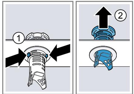
5. Passez les éléments filtrants sous l'eau courante pour les nettoyer. Nettoyer attentivement la bordure de saleté entre le filtre grossier et le filtre fin.
