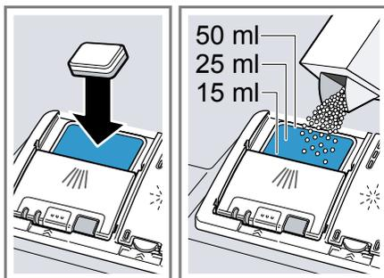
Une pastille suffit, le cas échéant. Déposez la pastille en diagonale. Si vous utilisez du détergent en poudre ou liquide, observez les indications de dosage du fabricant et la graduation du dosage du compartiment à détergent. 20 à 25 ml de détergent suffisent pour la vaisselle à souillure normale. Si la vaisselle est peu sale,
