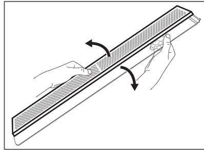
3. Assemblez une nouvelle membrane dans le couvercle en appuyant sur le bord de la membrane dans le couvercle.
