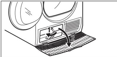
4. Si nécessaire, retirez les peluches sur le condenseur et dans son compartiment. Vous pouvez utiliser un aspirateur avec une brosse.
