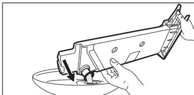
3. Remettez le raccord en plastique et le bac d'eau de condensation en position.
